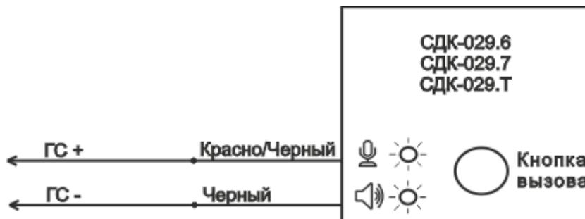
Рис. 1. Подключение СДК-029Т, СДК-029.6, СДК-029.7
